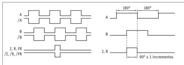
⚠ El estado lógico de las señales A y B no está definido respecto a la señal de índice I o la señal de referencia R. Puede desviarse de la imagen de la señal.
