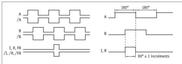
⚠ L'état logique des signaux A et B n'est pas défini en rapport au signal index 1 ou signal de référence R. Il peut être différent de la représentation du signal.
