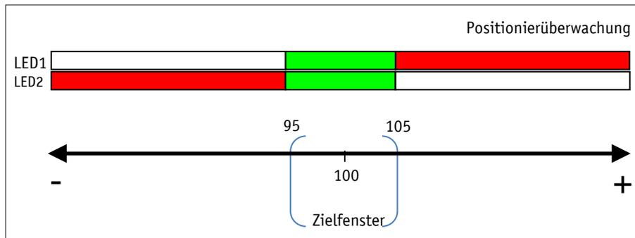
Abb. 3: Positionierüberwachung mit TargetWindow
